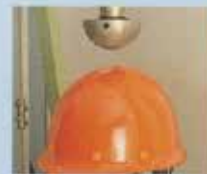
衝撃吸収性試験 保護帽の衝撃吸収性を計る試験。5kgの鉄半球を鉄平板を落下高さ1mの地点から落として測定します。
